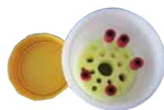
**Cuve hermétique (crochet EPS ou EPE pour fixer les tubes à essais, 16 emplacements de tubes à essais D10 et 2 emplacements de tubes à essais D15)**
